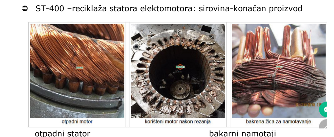
Slika 9: Polazne sirovine (otpad), i konačan proizvoda nakon tretmana otpada na mašini ST-400-STATORI ELEKTROMOTORA
