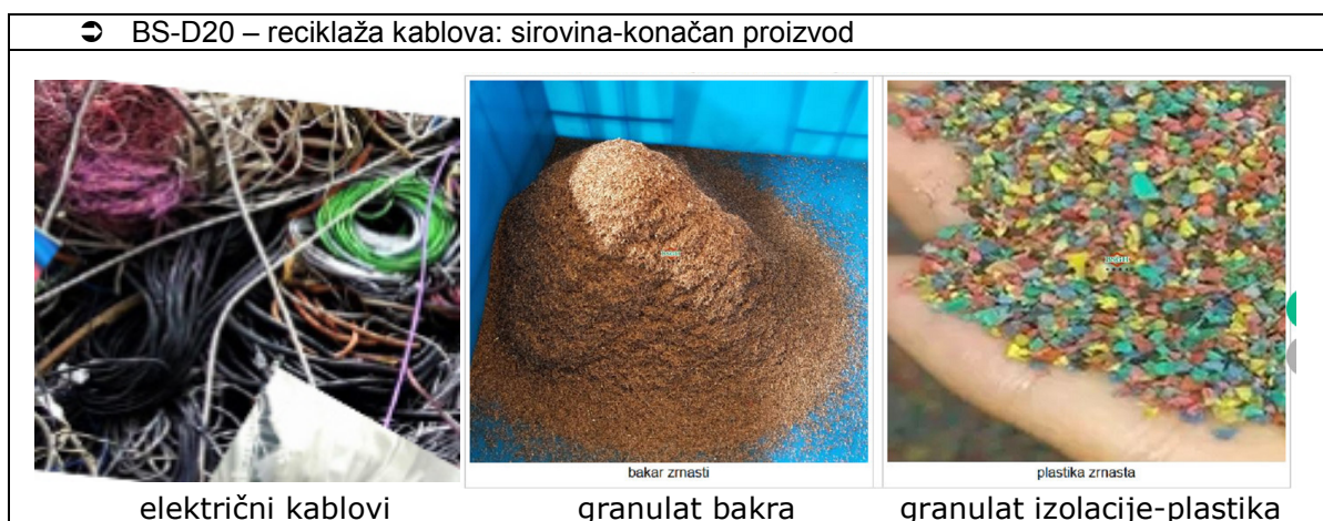
Slika 10: Polazne sirovine (otpad), kao i konačan proizvoda nakon tretmana otpada na mašini BS-D20 - ELEKTRIČNI KABLOVI
