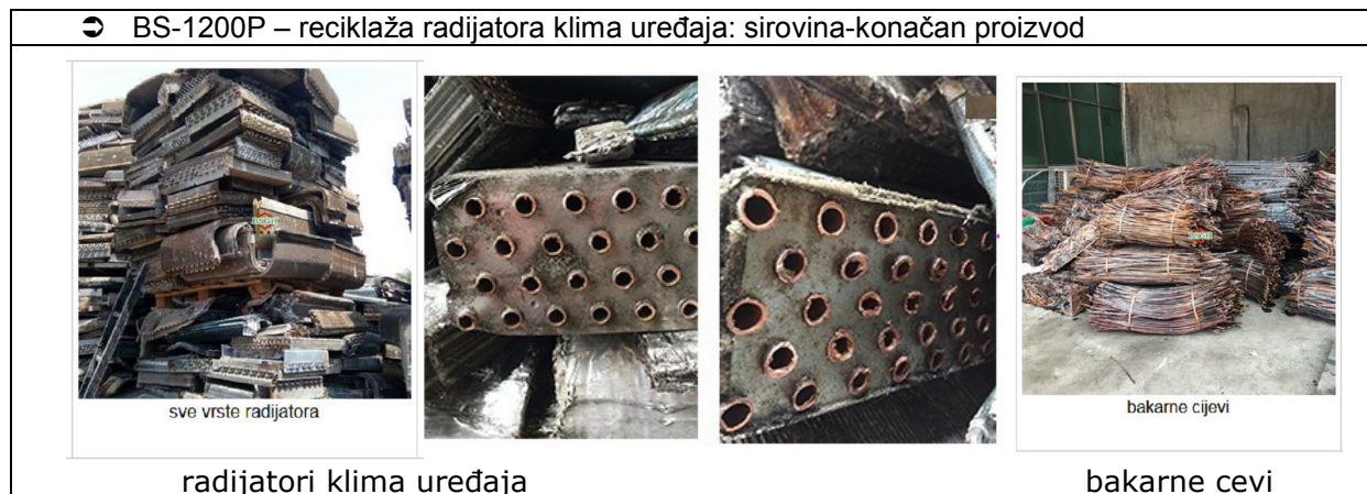
Slika 11: Polazne sirovine (otpad), kao i konačan proizvoda nakon tretmana otpada na mašini BS-1200P - RADIJATORI-KONDENZATORI KLIMA UREĐAJA
