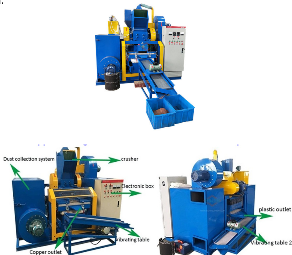
Slika 6: Mašina tip - BS-D20; Materijalni tokovi mašina tip - BS-D20
